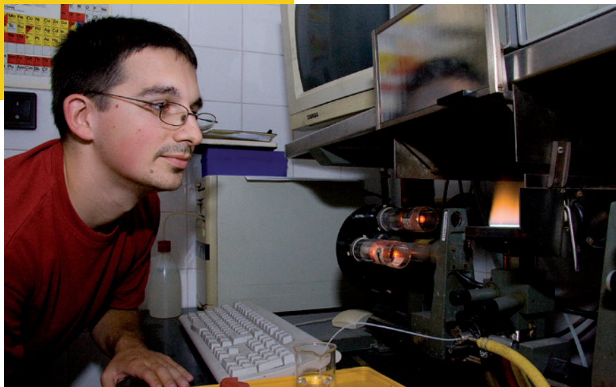
Onderzoeker Dénes Janke in de weer met vlam-AAS; zijn fabrikantenopstelling voor de bepaling van kwikgehalten in spaarlampen mocht niet op de foto.
